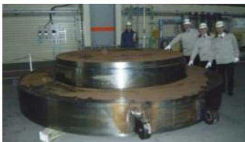
Fig. 3.23b: Ferro del magnete dopo la forgiatura
