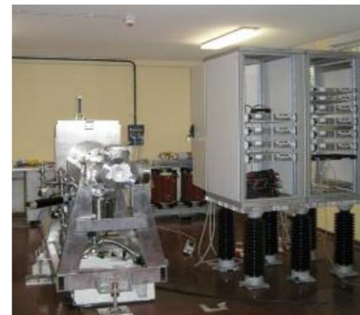
Fig. 4.14: Front-end del bersaglio ISOL.
