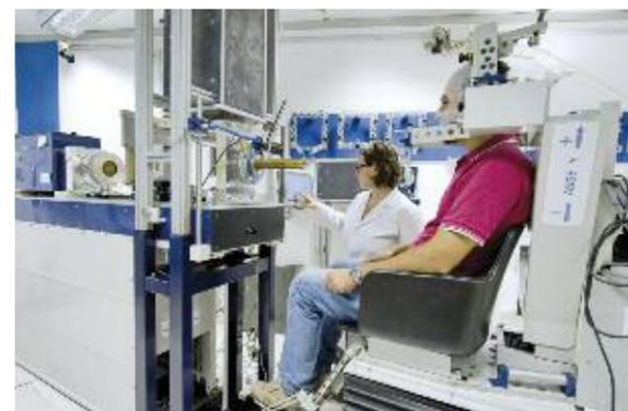
Fig. 4.24: Particolare della linea di fascio CATANA (LNS) per la terapia del melanoma oculare.
