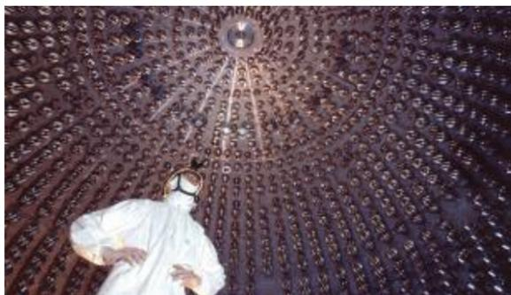
Fig. 4.10: L'esperimento Borexino per la rivelazione dei neutrini, ai Laboratori Nazionali del Gran Sasso.
