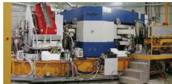
Fig. 4.23: Lo spettrometro magnetico MAGNEX, Laboratori Nazionali del Sud
