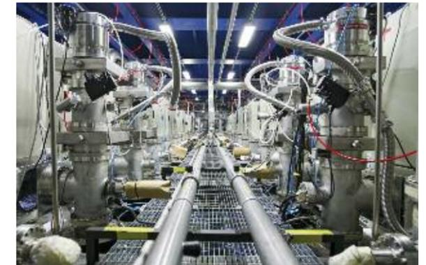
Fig.4.11: Il sistema di criogenia dell'esperimento ICARUS per la rivelazione dei neutrini, ai Laboratori del Gran Sasso.
