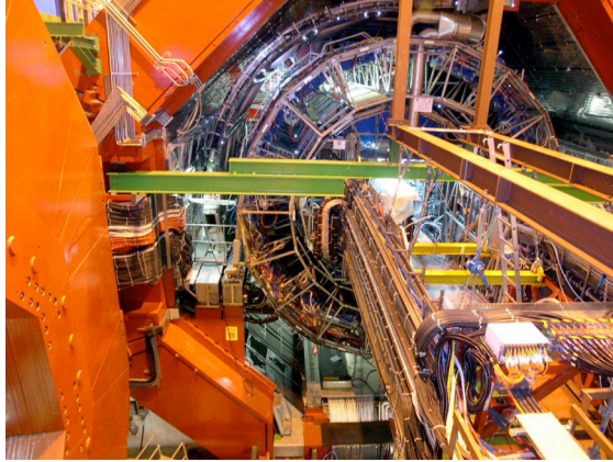
Foto dell'apparato ALICE che mostra l'inserimento del tracciatore centrale (ITS)
