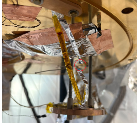
Figura 20: Bandella di alluminio ultrapuro preparata per la seconda fase delle misure descritte. In rosso è evidenziato il taglio compiuto su una delle due strips .
