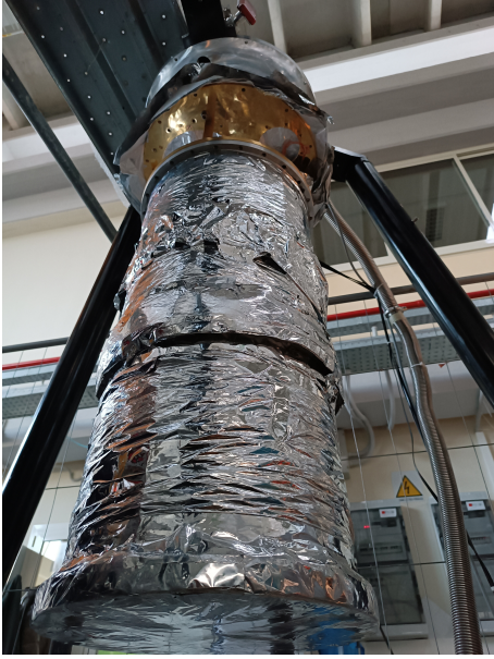
Figura 11: A sinistra: primo schermo termico, termalizzato al piatto a 4 K. A destra: montaggio del secondo schermo termico, termalizzato al piatto a 40 K.
